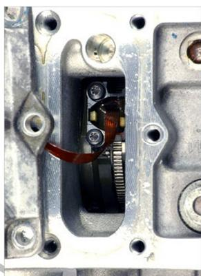
Pour démonter le capteur d'angle de rotation de la pompe, sont deux vis TORX TX10 visibles. Prenez de préférence un tournevis à pointe magnétique afin d'éviter que les vis tombent dans le corps de pompe.
