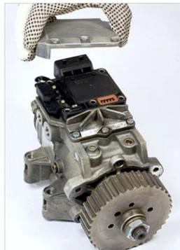
**Identifier ou marquer** les câbles électriques de la broche (position 2) **afin de ne pas les inverser** lors du remontage ultérieur. Les couper de différentes longueurs à la pince coupante (minimum à 15mm du boîtier).
