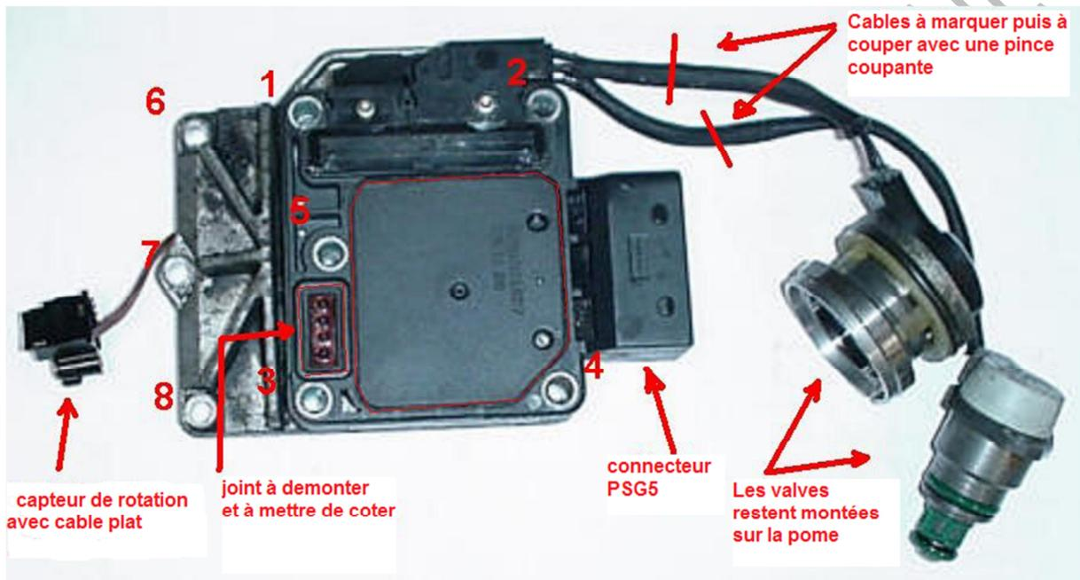
Premièrement, débrancher le connecteur PSG5 après avoir retiré le clip de verrouillage sur le calculateur et les cinq vis TORX TX25 (position 1-5) du couvercle supérieur et enlevé le.
