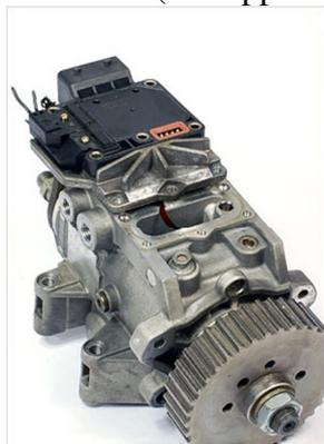
**ATTENTION:** Le capteur d'angle de rotation est vissé dans la pompe et sa nappe n'est pas démontable
